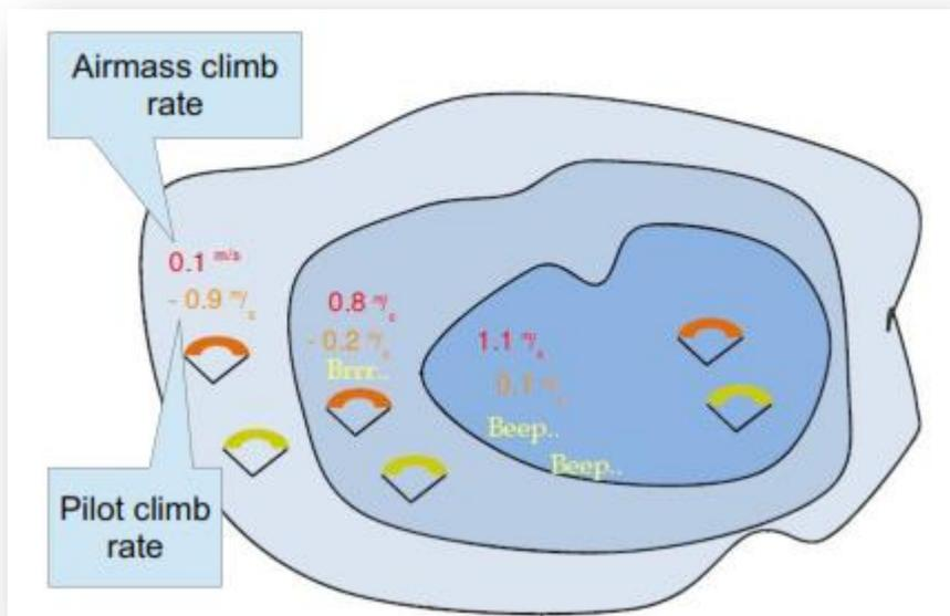
Рисунок 4.31 Работа баззера
