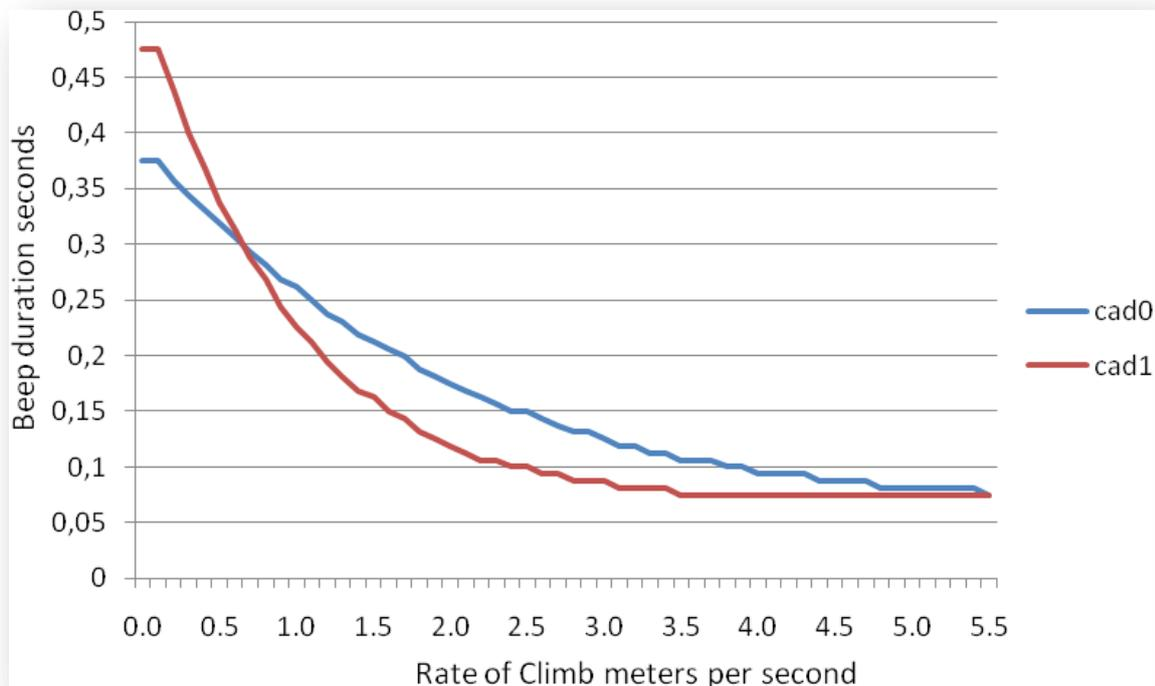
Рисунок. 4.30 Зависимость темпа сигнала вариометра от скороподъемности.
