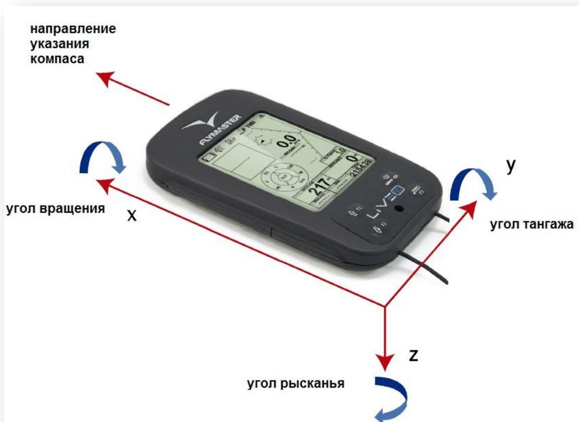
Рисунок 7.2 Углы калибровки магнитометра
